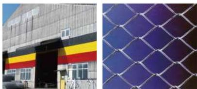
明治 29 年創業の株式会社小財スチールで働く坂本裕二さん。一番のやりがいを聞いてみたところ、作った製品が災害現場で役に立つことだと話す。例えば、ひし形金網は、ロックネットと呼ばれ、落石防止の製品となり、このおかげで土砂崩れが起きた時に落下する落石エネルギーを抑えることができ、被害を最小限に抑えることができるようになってきているようだ。
